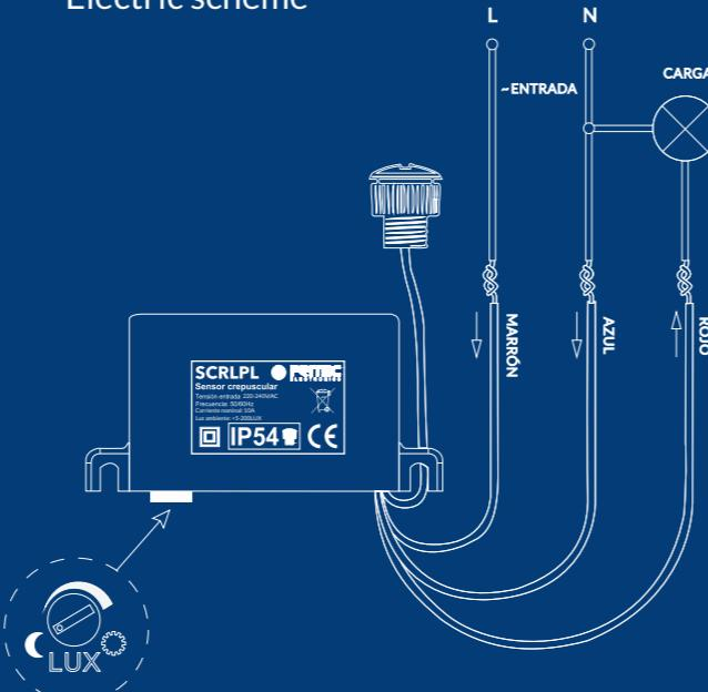
Ajuste del sensor de 5 a 400 Lux.
