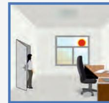
Si la luz ambiental es superior al umbral de luz seleccionado en el sensor, la carga no se encenderá cuando se detecte movimiento.
