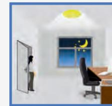
Con luz ambiental menor que el umbral de luz seleccionado en el sensor, la lámpara se encenderá al 100% cuando se detecte movimiento.
