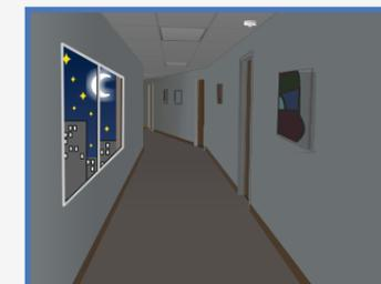
Cuando no hay suficiente luz ambiental, el detector se activa. Sin detección, la lámpara permanece apagada todo el tiempo.
