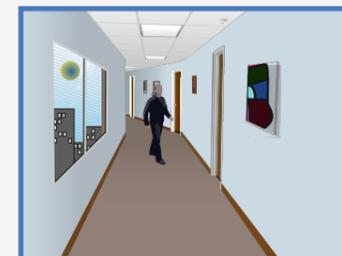
Mientras hay suficiente luz ambiental, el sensor permanece desconectado, si hay detección de movimiento no se enciende la lámpara.
