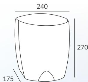
El modelo db9 permite ahorrar energía ya que con solo 900w y gracias a los 230Km/h de velocidad de salida en la tobera, permite un secado más rápido y con menor energía que un secamanos convencional. Adicionalmente, es posible desconectar la resistencia calefactora con un simple interruptor en su interior, lo que permite un menor consumo (600W).
